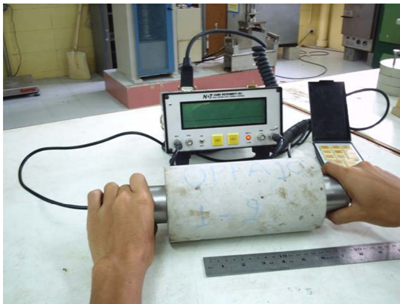
รูปที่ 3.6 การทดสอบความเร็วคลื่นอัลตราโซนิคแสดงขนาดก้อนตัวอย่างและชุดเครื่องมือทดสอบ
