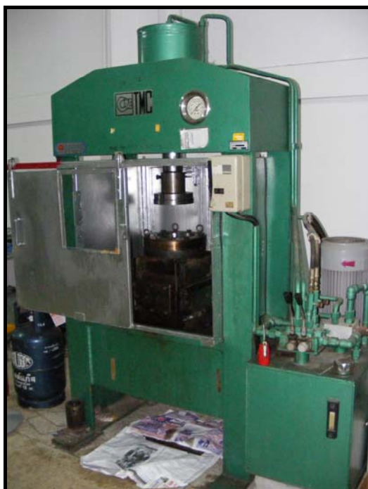
รูปที่ 2.17 แสดงรูปเครื่องอัดไฮดรอลิกความดันสูง ยี่ห้อ TMC
