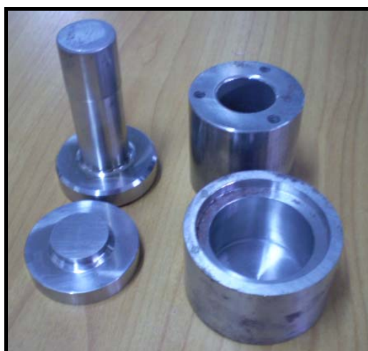
รูปที่ 2.13 แสดงรูปแม่พิมพ์ทำจากเหล็กเครื่องมือ SKD11
