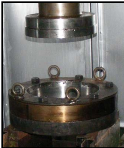
รูปที่ 2.16 แสดงรูปแม่พิมพ์เหล็ก Medium Carbon (0.35%C)
