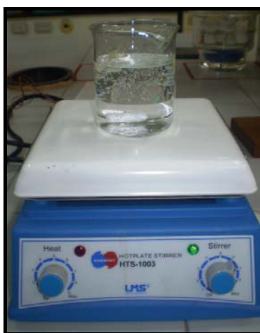
รูปที่ 2.7 แสดงรูปเครื่องกวนผสม (Magnetic Stirrer) ยี่ห้อ LMS รุ่น MGS-1001
