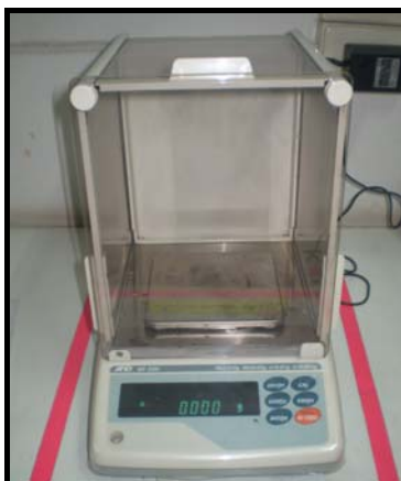
รูปที่ 2.3 แสดงรูปเครื่องชั่งสาร 3 ตำแหน่ง รุ่น GF-300 ยี่ห้อ AND
