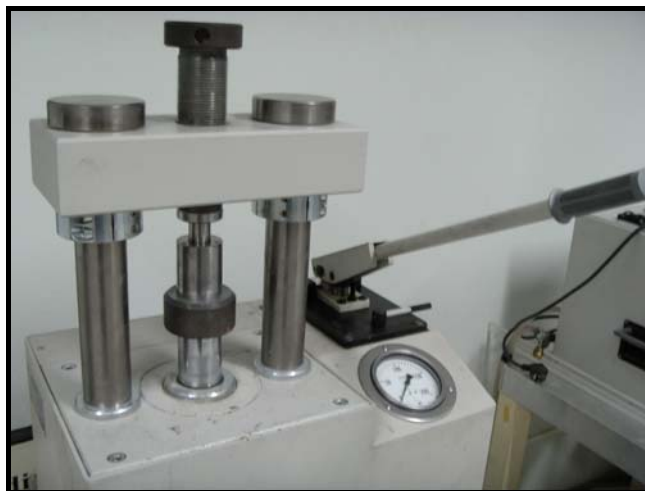
รูปที่ 2.14 แสดงรูปเครื่องอัดไฮดรอลิก ยี่ห้อ Herzog
