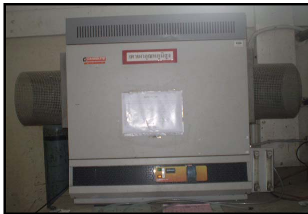
รูปที่ 2.5 แสดงรูปเตาเผาอุณหภูมิสูง (Tube Furnace; อุณหภูมิสูงสุด 1800 °C)
