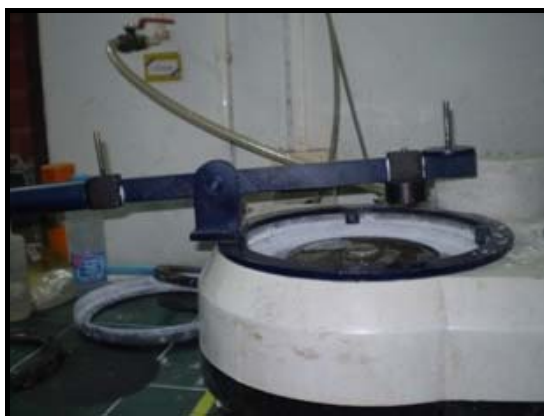
รูปที่ 2.21 แสดงรูปเครื่องทดสอบการสึกหรอแบบ pin on disk
