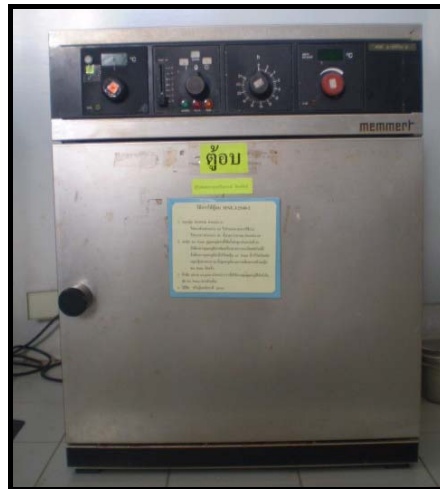
รูปที่ 2.4 แสดงรูปตู้บ่มรุ่น Precision Incubator ยี่ห้อ Memmert
