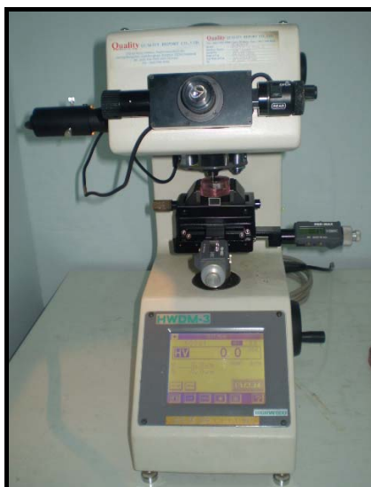
รูปที่ 2.20 แสดงรูปเครื่องทดสอบความแข็ง รุ่น HWDM-3 ยี่ห้อ high wood
