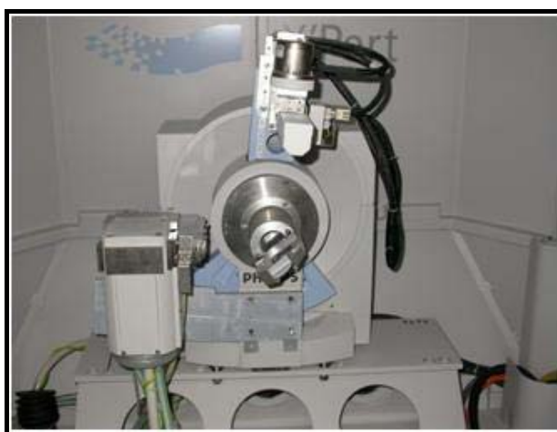
รูปที่ 2.18 แสดงรูปเครื่อง X-ray Diffractometer (XRD) ยี่ห้อ PHILIPS รุ่น X'Pert MP
