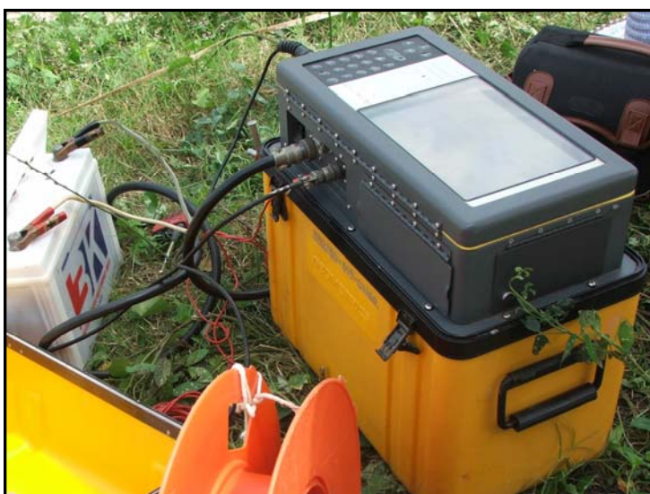
ภาพประกอบ 2.1 เครื่องบันทึกคลื่นสั้นสะเทือน Geometric SmartSies S-24 และ แบตเตอรี่
