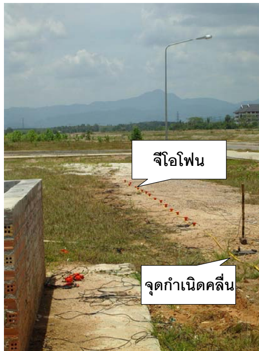
ภาพประกอบ 2.11 การจัดวางจุดกำเนิดคลื่น S จีไอโฟน G บนแนววัดคลื่นสั้นสะเทือนหักเห
