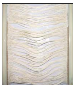
ภาพประกอบ 9 ชุดเมมเบรนประเภทเส้นใยทอกลวง (Hollow fiber membrane)
