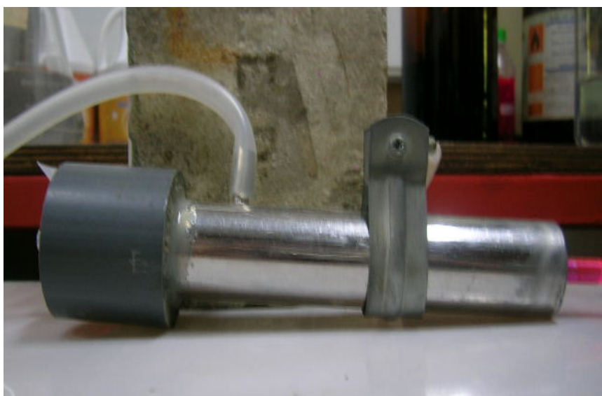
ภาพประกอบที่ 15 แสดงโอโซนเซอร์ที่ใช้ในงานวิจัย
