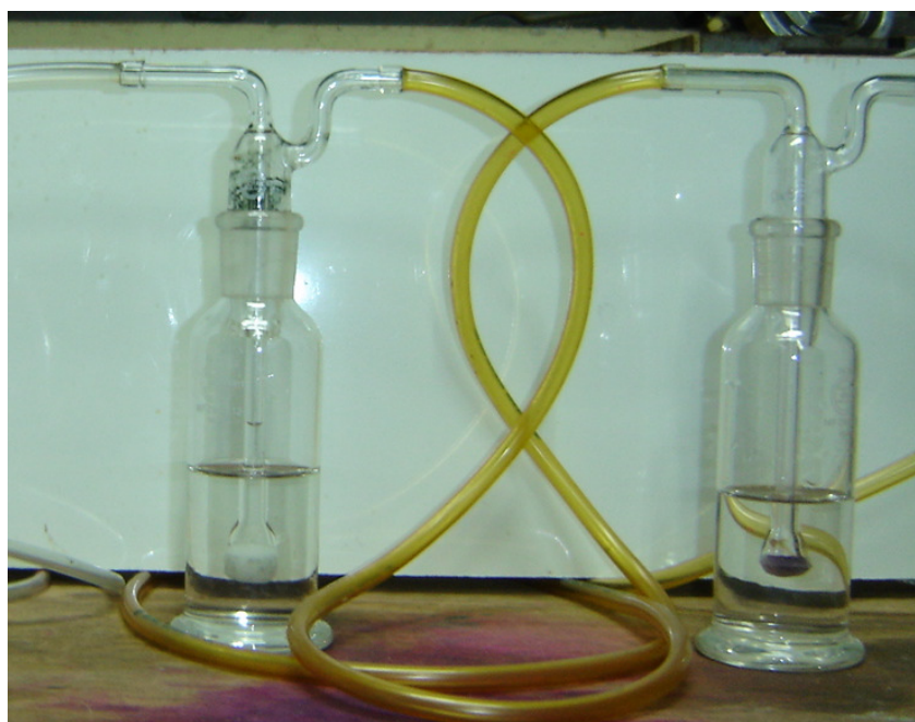
ภาพประกอบที่ 21 แสดงการต่อ midget imprinter 2 ขวด ต่ออนุกรมที่ใช้วัดปริมาณไอโชน
