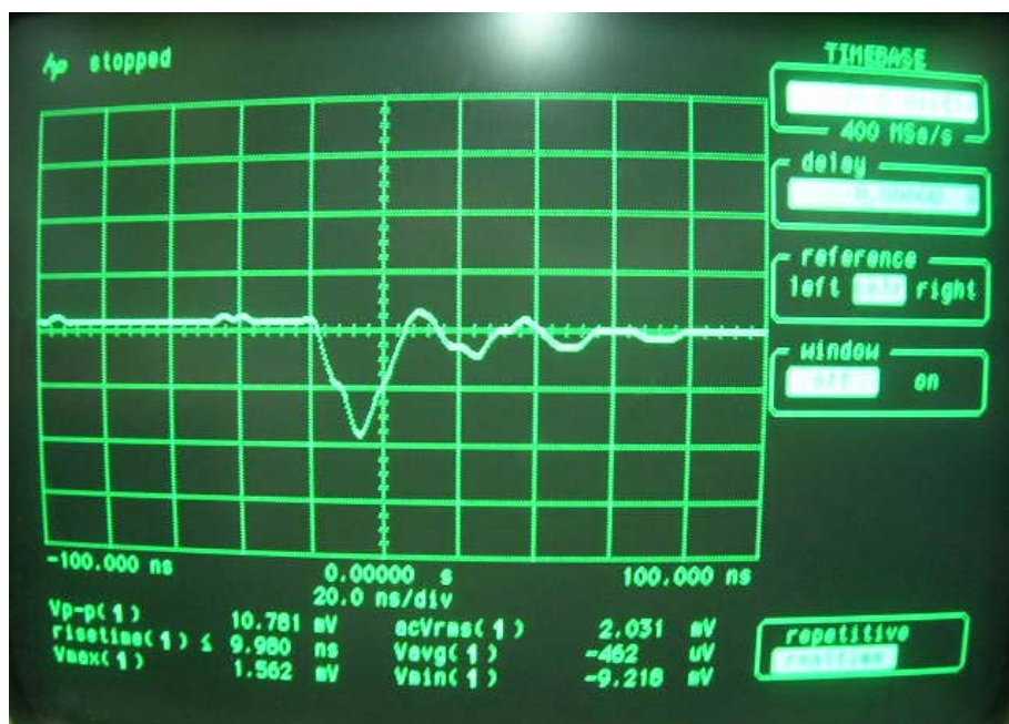
ภาพประกอบที่ 26 แสดงสัญญาณของกระแสชาร์จที่ความต่างศักย์ไฟฟ้า 2 กิโลโวลต์ และอัตราการไหลก๊าซออกซิเจน 8 ลิตรต่อนาที
