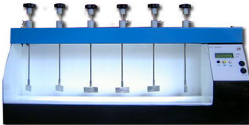
ภาพประกอบที่ 19 แสดงเครื่องมือสำหรับการทำ Jar Test
