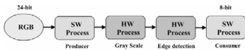
รูปที่ 4 การหาขอบภาพด้วยโครงสร้างแบบเดี่ยว
