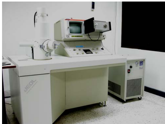
ภาพประกอบ 3.2 กล้องจุลทรรศน์อิเล็กตรอนแบบส่องกราด (JSM-5800LV, JEOL)
