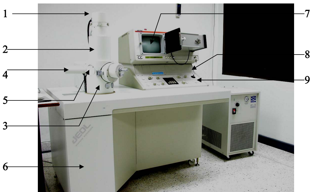
ภาพประกอบ ง.4 แสดงภาพกล้องจุลทรรศน์อิเล็กตรอนแบบส่องกราด รุ่น JSM-5200
