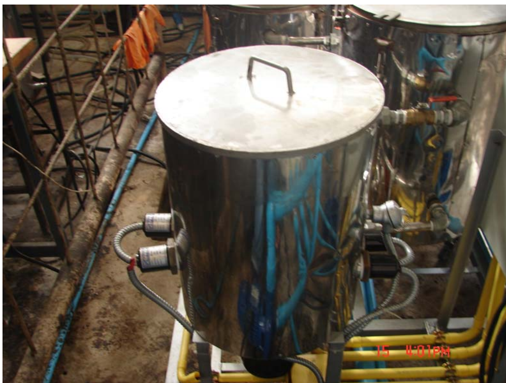
ภาพประกอบที่ 58 ภาพถ่ายถังให้ความร้อนที่จัดสร้างสำหรับชุดสกัดแบบแบทช์
