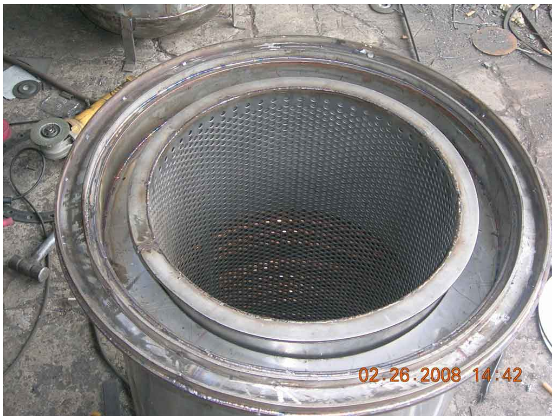
ภาพประกอบที่ 47 ภาพถ่ายถึงสก็ดพร้อมถังตะแกรงที่จัดสร้างสำหรับชุดสก็ดแบบแบทช์
