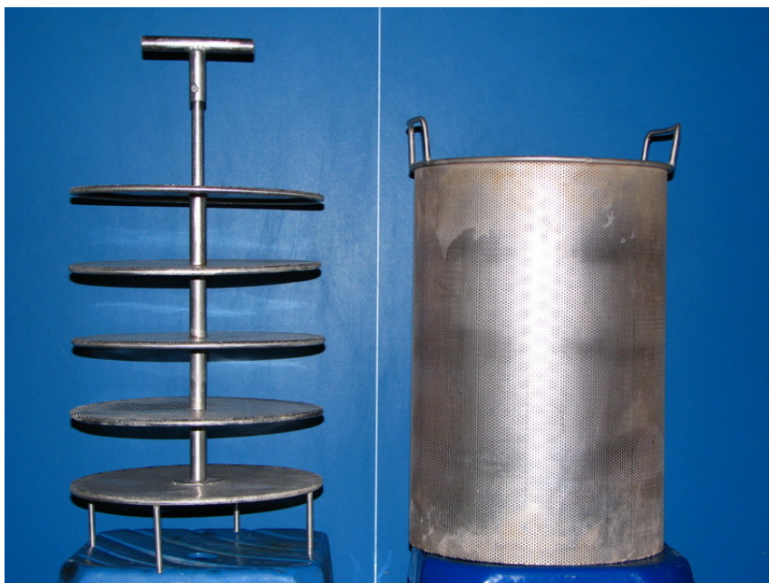
ภาพประกอบที่ 35 แผ่นตะแกรงและถังตะแกรงสแตนเลส
