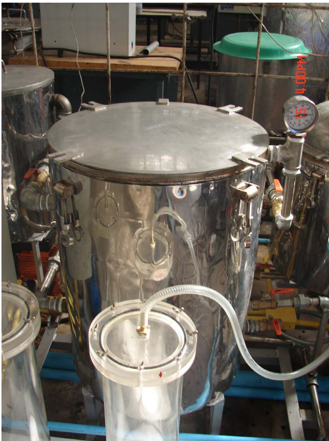
ภาพประกอบที่ 49 ถึงสกัดที่ประกอบกับชุดสกัดแบบเบทซ์
