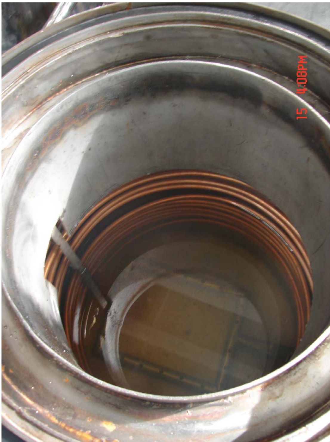
ภาพประกอบที่ 48 ภาพถ่ายด้านในถังสกัดที่จัดสร้างสำหรับชุดสกัดแบบแบทช์
