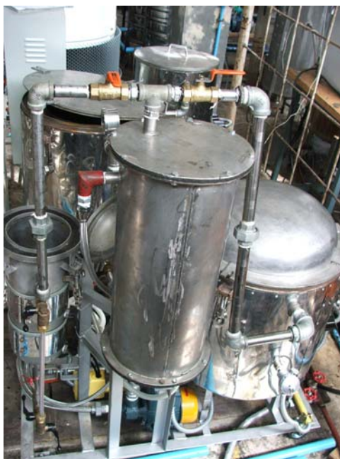
ภาพประกอบที่ 56 ภาพถ่ายเครื่องควบแน่นที่จัดสร้างสำหรับชุดสกัดแบบเบทซ์
