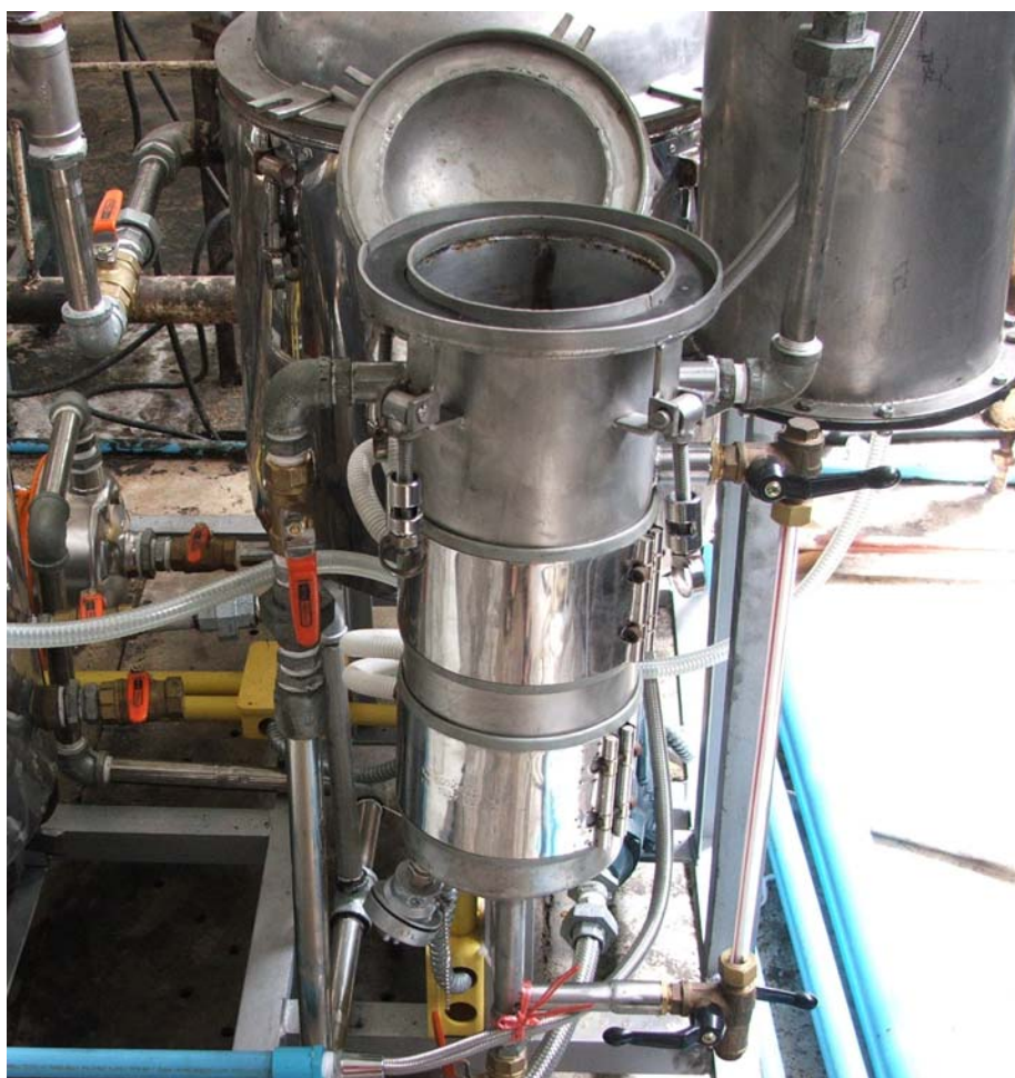
ภาพประกอบที่ 54 ภาพถ่ายถึงระเหยขนาดเล็กที่จัดสร้างสำหรับชุดสกัดแบบเบทซ์
