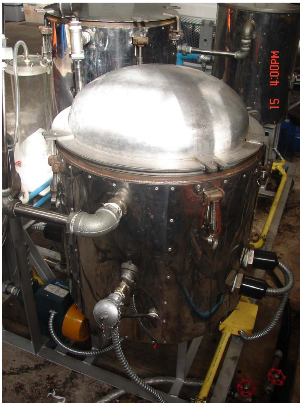
ภาพประกอบที่ 52 ถังระเหยขนาดใหญ่ที่ประกอบด้วยชุดสกัดแบบเบตซ์
