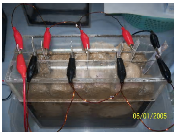
รูปภาคผนวก ข 1 การจัดเรียงอิเล็กโทรดแบบขนาน
