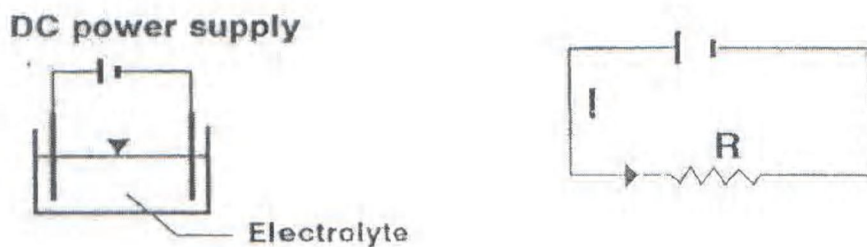
รูปที่ 2.10 การจัดเรียงแผ่นอิเล็กโทรดโมโนโพลาร์เซลล์เดี่ยว
