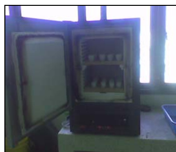
รูปที่ 2-5 การย่อยตัวอย่างเนื้อเยื่อให้เป็นสารละลายเพื่อวิเคราะห์ทางเคมี: รูปขวา – ทำตัวอย่างให้แห้งตั้งบนเตาให้ความร้อน (hot plate) ที่อุณหภูมิ 100°C และรูปซ้าย – การเผาตัวอย่างในเผาแบบตั้งโปรแกรม (programmable ash muffle furnace) โดยเพิ่มอุณหภูมิเป็นลำดับขั้น จาก 100°C เป็น 450°C ด้วยอัตรา 50°C ต่อชั่วโมง
