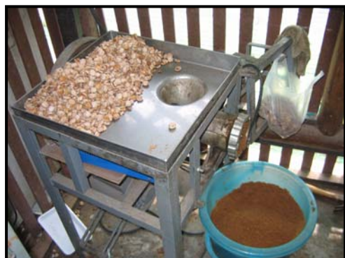
ภาพภาคผนวกที่ 6 เครื่องบดเนื้อในเมล็ดขางพารา
