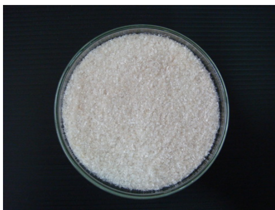
ภาพประกอบ 5-4 ไคโตซานที่ผลิตจากเปลือกกุ้งด้วยเครื่องต้นแบบ
