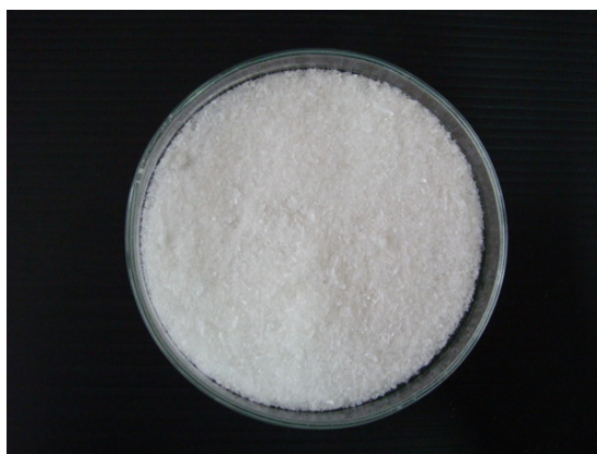
ภาพประกอบ 5-3 ไคโตซานที่ผลิตจากกระดองปลาหมึกด้วยเครื่องต้นแบบ
