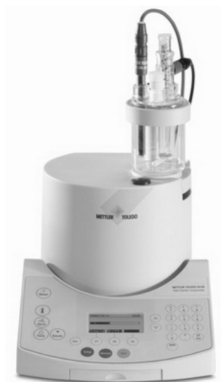
ภาพประกอบที่ ก.1 เครื่อง Karl Fisher Coulometer ของบริษัท Mettler รุ่น DL39
