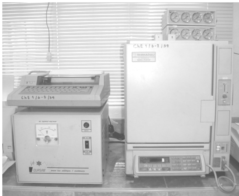
ภาพประกอบที่ 12 เครื่องแก๊สโครมาโทกราฟ ยี่ห้อ SHIMADZU รุ่น 14B ดีเทคเตอร์แบบ FID
