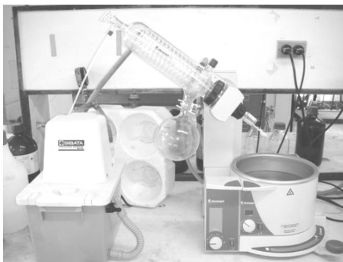
ภาพประกอบที่ 14 เครื่องระเหยสุญญากาศแบบหมุน
