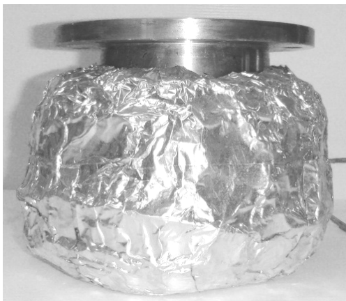
ภาพประกอบที่ 6 ถังปฏิกรณ์แบบกะสำหรับผลิตไดเอทิลอีเทอร์
