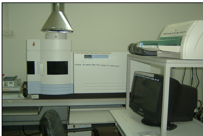
รูปที่ ก - 1 เครื่องมือ Inductively Coupled Plasma - Optical Emission Spectroscopy (ICP-OES) ยี่ห้อ Perkin-Elmer รุ่น Optima 2000 DV
