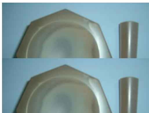
รูปที่ จ-1 โกร่งโมราและสากโมรา (agate mortar and pestle)
