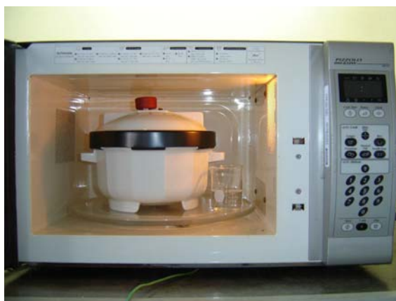
รูปที่ ๑-2 การจัดเรียงหม้ออัดความดันและบีกเกอร์น้ำในเตาไมโครเวฟ
