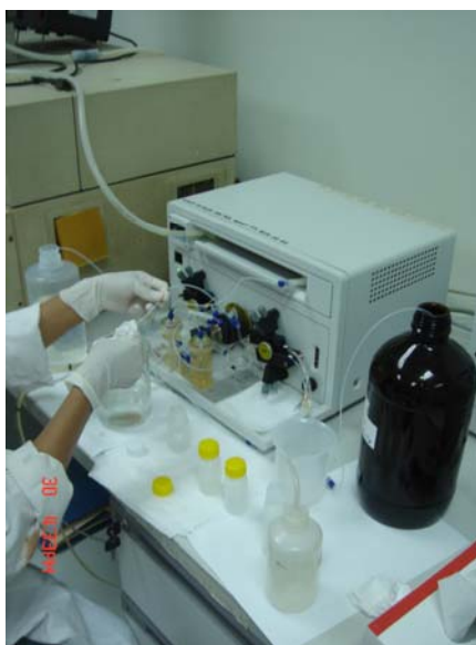
รูปที่ จ-1 การตรวจวัดความเข้มข้นของปรอทโดยเทคนิค hydride generation ด้วยเครื่องวิเคราะห์หาปรอท Perkin-Elmer FIMS TM 400
