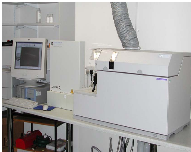
รูปที่ ฉ-1 การตรวจวัดความเข้มข้นของสารหนูโดยเทคนิค ICP-MS ด้วยเครื่องวิเคราะห์ธาตุ ICP-MS ยี่ห้อ Agilent
