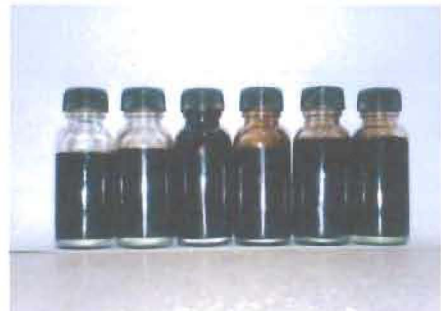
เมทิลเอสเทอร์จากสารอินทรีย์ที่แยกจากกลีเซอรอล ของน้ำมันพืชทอดใช้แล้ว
