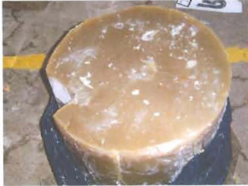
ภาพประกอบที่ 5 กลีเซอรอลดิบที่ได้จากกระบวนการทรานส์เอสเตอริฟิเคชันน้ำมันปาล์มสเตียริน
