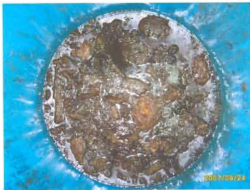
ภาพประกอบที่ 6 กลีเซอรอลดิบที่ได้จากกระบวนการทรานส์เอสเตอริฟิเคชันน้ำมันพืชทอดใช้แล้ว
