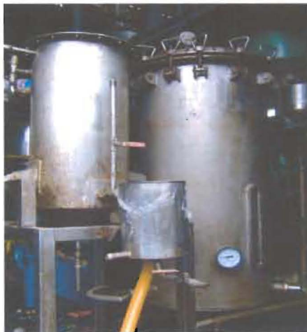
ภาพประกอบที่ 14 ชุดต้นแบบในการผลิตเมทิลเอสเทอร์แบบกะขนาด 40 ลิตร
