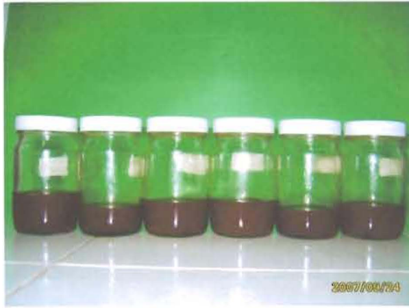
ภาพประกอบที่ 7 ลักษณะทางกายภาพของสารอินทรีย์ที่แยกจากเฟสกลีเซอรอล ของกระบวนการทรานส์เอสเตอร์ฟิเคชันน้ำมันพืชทอดใช้แล้ว
