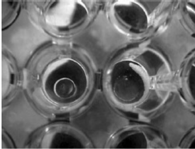
ภาพที่ 4-1 ลักษณะหยดน้ำมันเครื่องเมื่อทดสอบด้วยวิธี drop-collapse แล้วยังคงเม็ดกลมๆ ไม่เกิดการสลายตัวของหยดน้ำมันเครื่อง (ด้านซ้าย) และเกิดการสลายตัวของหยดน้ำมันเครื่อง (ด้านขวา)
