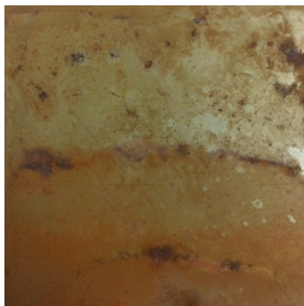
รูปที่ 4.2 การเกิดสนิมบนฟิล์มโพลีเอทิลีนไดออกไซด์
