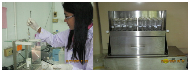
ภาพที่ 2-3 การชั่งตัวอย่างและการย่อยตัวอย่างด้วยเครื่องย่อย (Block Digestion System)
