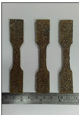
รูปที่ 3.9 ขนาดและรูปทรงของวัสดุเพื่อทดสอบความต้านทานแรงดึง
