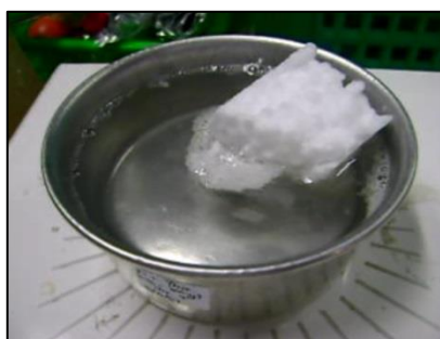
รูปที่ 3.4 การละลายโฟมพอลิสไตรีน โดยใช้เครื่อง Hot plate Magnetic stirrer
