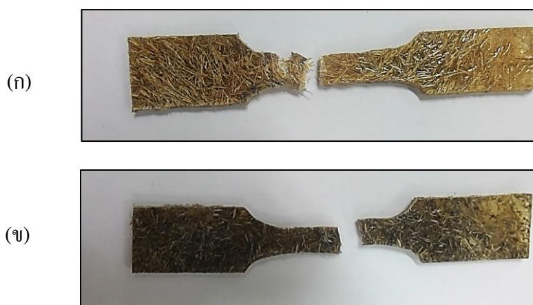
รูปที่ 4.14 การขาดออกกายหลังการทดสอบความทนต่อแรงดึงของวัสดุเชิงประกอบพอลิस्टาไตรีนรีไซเคิลกับเส้นใยธรรมชาติ (ก) PS + 5% TC และ (ข) PS + 5% TB
