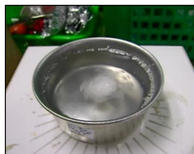
รูปที่ 3.4 การละลายโฟมพอลิสไตรีน โดยใช้เครื่อง Hot plate Magnetic stirrer
