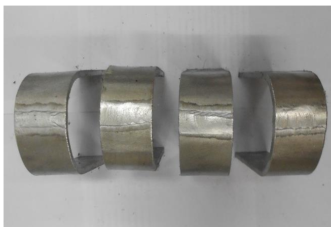
รูปที่ 4.28 เงื่อนไข Al 6082T6 - 4 mm - Filler 4043 (เชื่อมใหม่)
