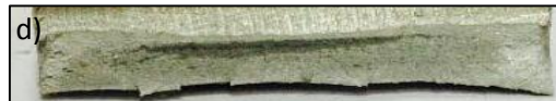
รูปที่ 4.22 แสดงพื้นที่หน้าตัดการแตกหักของอะลูมิเนียมผสม 6082T6 เชื่อมด้วยลวดเชื่อม 4043
