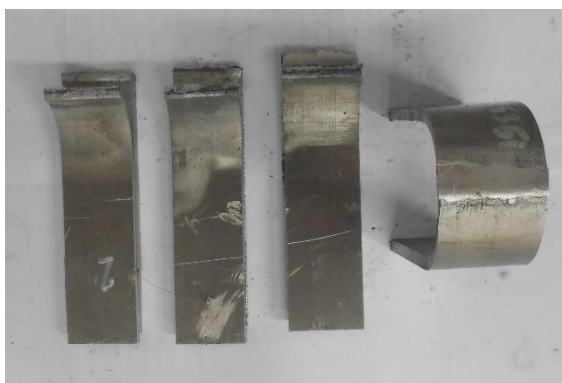
รูปที่ 4.34 เงานโซ่ Al 6082T6 - 6 mm - Filler 5356 (เชื่อมใหม่)
