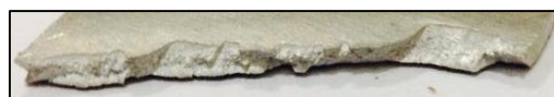
รูปที่ 4.20 แสดงพื้นที่หน้าตัดการแตกหักของอะลูมิเนียมผสม 6082T6 และอะลูมิเนียมผสม 5083
