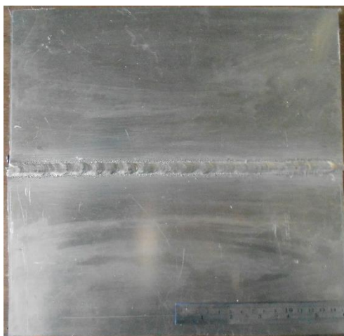
รูปที่ 3.17 ชิ้นงานหลังจากการเชื่อม
