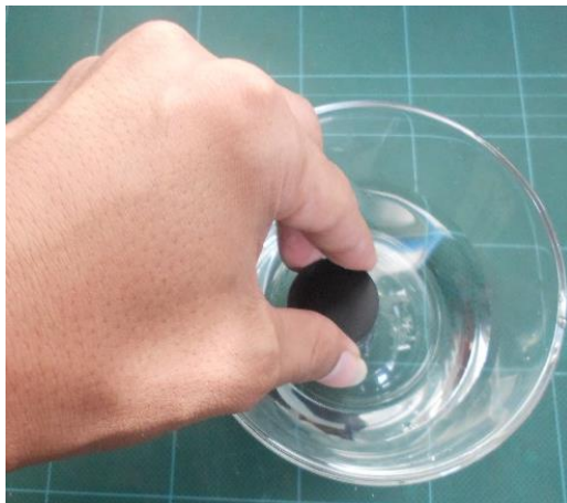
รูปที่ 3.23 การจุ่มชิ้นงานลงในกรด
