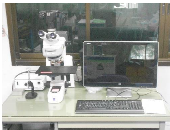
รูปที่ 3.10 กล้องจุลทรรศน์แบบใช้แสง มีกำลังขยาย 25-500 เท่า
