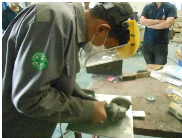
รูปที่ 3.15 แสดงการทำความสะอาดผิวชิ้นงาน
