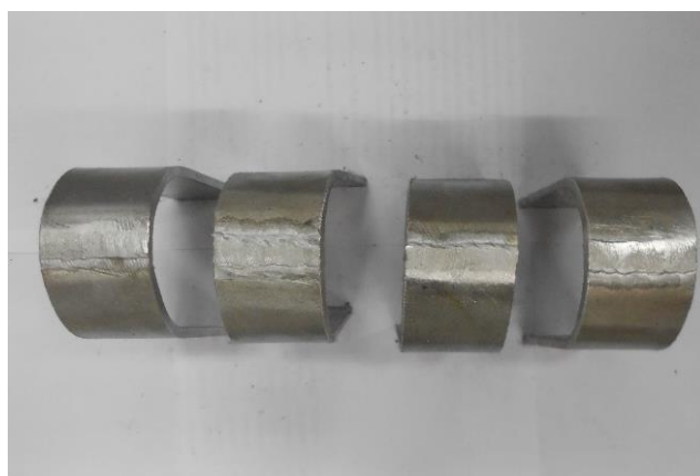
รูปที่ 4.29 เ็ื่อนไข Al 6082T6 - 4 mm - Filler 4043 (เชื่อมซ่อม)
