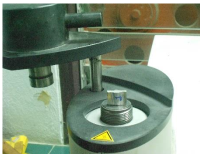
รูปที่ 3.18 การวางตำแหน่งบนแม่พิมพ์ทำเรือนแบบร้อน (hot mounting)
