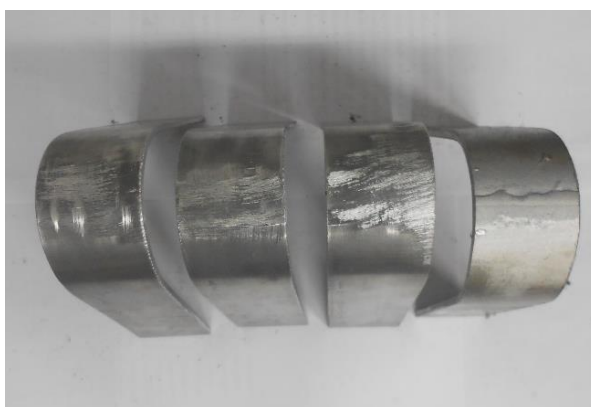
รูปที่ 4.36 เจ็อนไข Al 5083 - 3 mm - Filler 5356 (เชื่อมใหม่)
