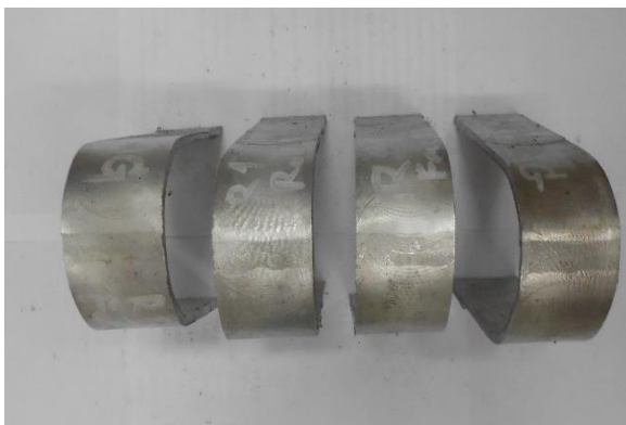
รูปที่ 4.31 เจ็อนไซ Al 6082T6 - 6 mm - Filler 4043 (เชื่อมซ่อม)
