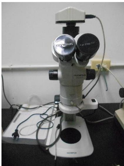
รูปที่ 3.9 กล้องจุลทรรศน์แบบใช้แสง มีกำลังขยาย 4-28 เท่า
