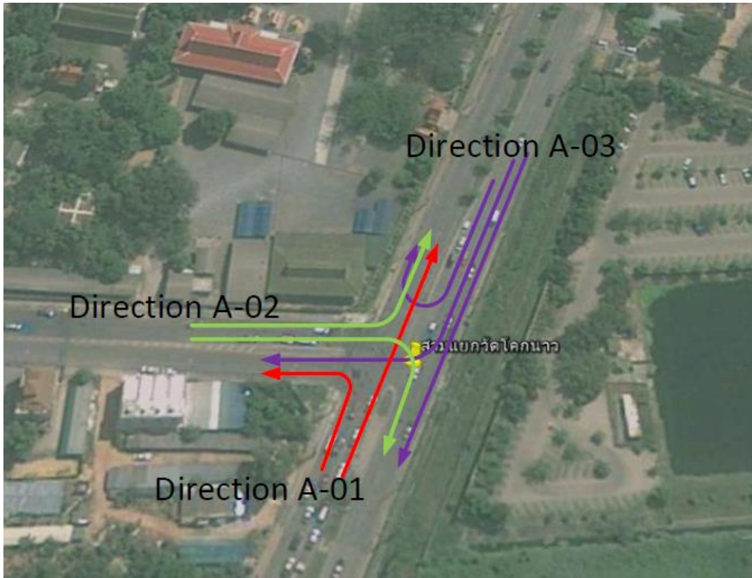
รูปที่ ข-3ก ทิศทางการสำรวจปริมาณการจราจรและความเร็วบริเวณทางแยกโคกนาว
