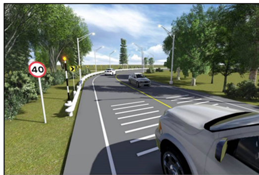
รูปที่ 4-38 ตัดแต่งต้นไม้ริมข้างทาง ติดตั้งแถบชะลอความเร็ว ไฟฟ้าส่องสว่างและป้ายจำกัดความเร็ว เพื่อเพิ่มความปลอดภัย
