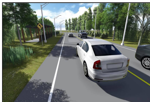
รูปที่ 4-36 ติดตั้งป้ายจราจรให้อยู่ในบริเวณที่เห็นได้ชัดเจนจากระยะไกล และซ่อมแซมป้ายให้อยู่ในสภาพพร้อมใช้งาน
