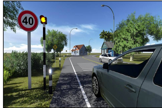
รูปที่ 4-28 ซ่อมแซมสัญญาณไฟเตือน ติดตั้งป้ายจำกัดความเร็ว และอุปกรณ์สะท้อนแสงให้อยู่ในสภาพพร้อมใช้งาน
