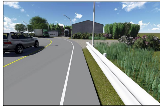
รูปที่ 4-30 ติดตั้งราวกันอันตราย ไฟฟ้าส่องสว่างและทำความสะอาดผิวจราจร เพื่อเพิ่มความปลอดภัย
