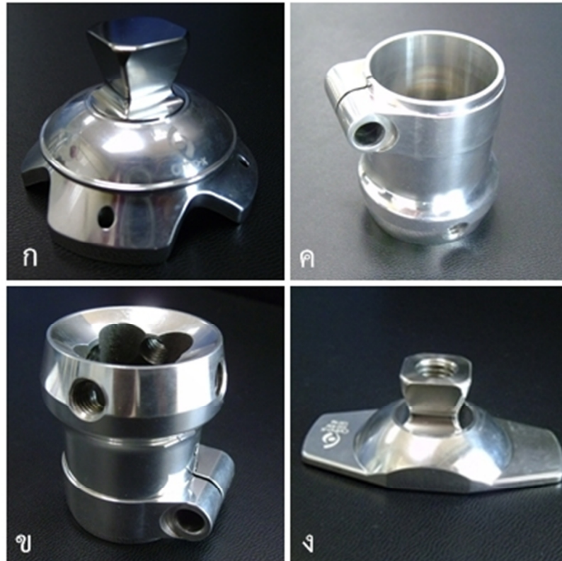
ภาพประกอบที่ 3.2 ผลิตภัณฑ์ชาเทียมอะลูมิเนียมน้ำหนักเบาจากกระบวนการหล่อฉีดโลหะแบบกึ่งกึ่งของแข็ง (ก) ชิ้นส่วนฐานรองรับเข้า (Socket Adapter) (ข) ชิ้นส่วนจับยึดระหว่างเข้ากับท่อชาเทียม (Tube Clamp) (ค) ชิ้นส่วนจับยึดระหว่างท่อชาเทียมกับข้อเท้าเทียม (Foot Clamp) และ (ง) ข้อเท้าเทียม (Foot Adapter)
