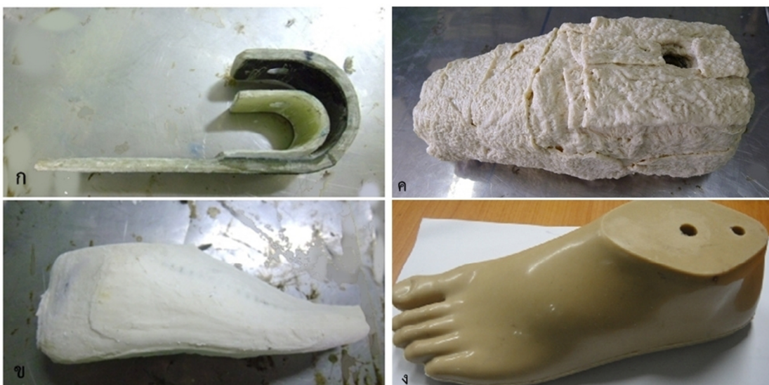
ภาพประกอบที่ 3.6 ส่วนประกอบของเท้าเทียมจากยางธรรมชาติ (ก) แกนภายใน (ข) เนื้อเท้าเทียมใช้โฟมสำหรับห่อหุ้มแกนภายใน (ค) ผิวเท้าเทียมผลิตจากยางคอมปาวนด์ และ (ง) เท้าเทียมจากยางธรรมชาติ
