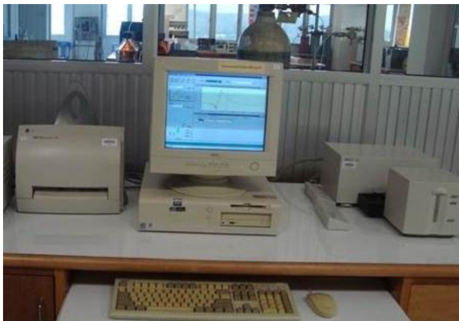
ภาพประกอบที่ 3-4 เครื่อง UV-Visible Spectrophotometer รุ่น HP 8453
