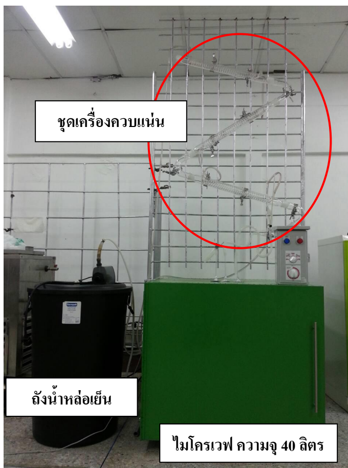
ภาพประกอบที่ 4-27 ชุดให้ความร้อนด้วยคลื่นไมโครเวฟสำหรับการปรับสภาพและย่อยเปลือก สับปะรดซึ่งมีตู้อุปกรณ์ปล่อยคลื่นไมโครเวฟความจุ 40 ลิตร
