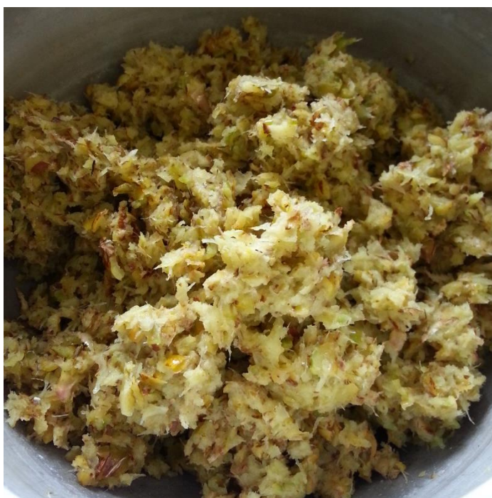
ภาพประกอบที่ 3-6 เปลือกสับประรดหลังบดขนาดไม่เกิน 3 มิลลิเมตร
