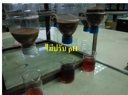
รูปที่ 4.6 ประสิทธิภาพการดูดซับสีของอิฐมอญขนาดเล็กกว่า 0.42 มิลลิเมตร จากน้ำต้มเทียนที่ไม่ได้ปรับ และปรับค่า pH
