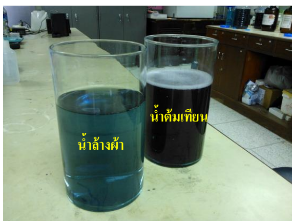
รูปที่ 4.5 น้ำเสียจากกระบวนการทำผ้าบาติก
