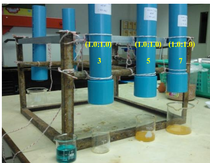
รูปที่ 4.10 ชุดทดลองที่ใช้สำหรับทดสอบความสามารถในการดูดซับสีจากตัวอย่างน้ำเสียที่ได้มาจากกระบวนการผลิตผ้าบาติก
