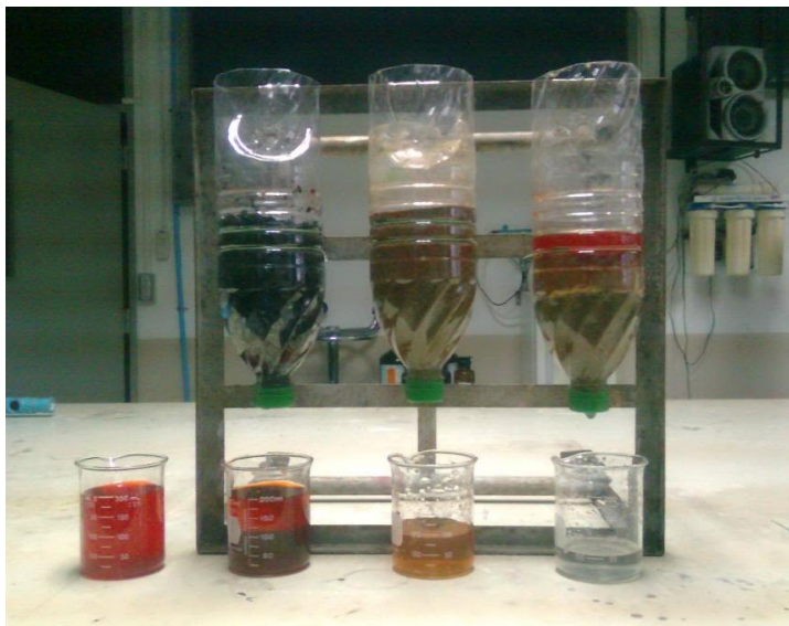
รูปที่ 4.1 การศึกษาขั้นต้นเปรียบเทียบประสิทธิภาพการดูดซับสีของ ถ่านกัมมันต์ ทรายละเอียด และอิฐมอญบด
