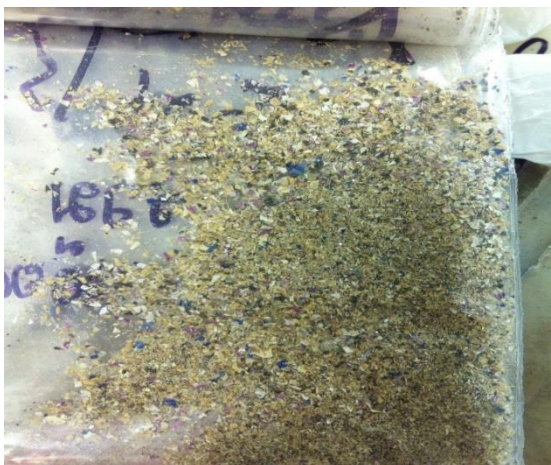
รูปที่ 2-7 ตัวอย่างมูลฝอยที่นำไปวิเคราะห์หาค่าความร้อน
