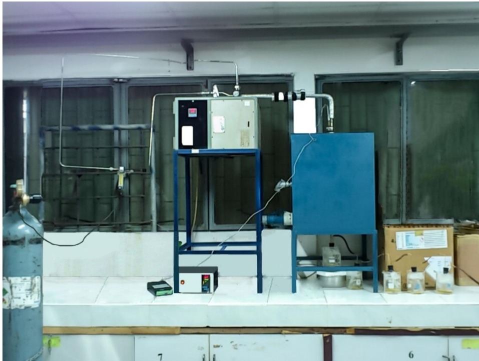
ภาพประกอบที่ 4-7 แสดงชุดอุปกรณ์สำหรับกระบวนการคละไคติกแครกกิ่ง
