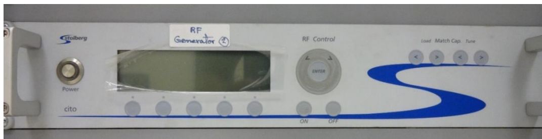
รูปที่ 2.3 เครื่องกำเนิดคลื่นความถี่วิทยุ RF Generator CITO 1310
