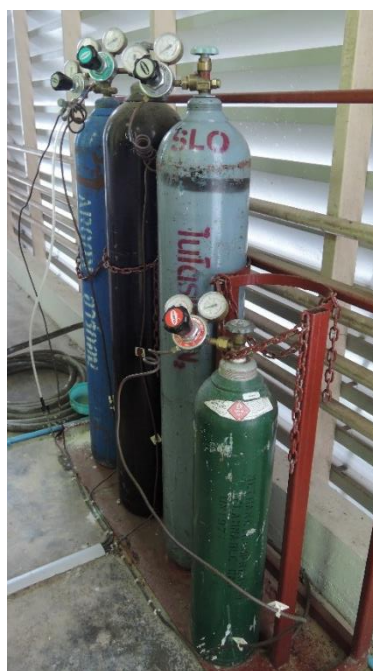
รูปที่ 2.7 แก๊สที่ใช้ในระบบการเคลือบฟิล์มคาร์บอนคล้ายเพชร
