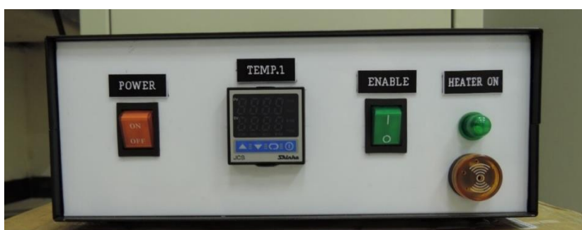
รูปที่ 2.5 ระบบควบคุมอุณหภูมิวัตต์ฐาน (Heater controller)
