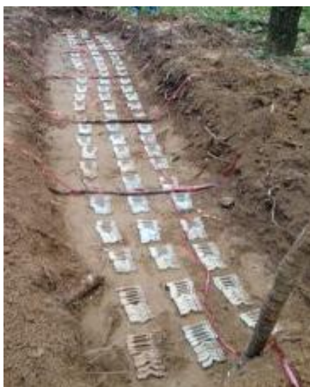
รูปที่ 3.12 หลุมทดสอบการย่อยสลายได้ทางชีวภาพโดยการฝังดิน
