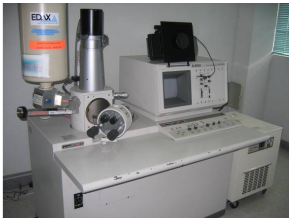
รูปที่ 3.8 เครื่องสแกนนิ่งอิเล็กตรอนไมโครสโคป (Scanning Electron Microscopy, SEM)
