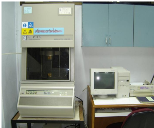
รูปที่ 3.4 เครื่องทดสอบเวลาการวัลคาไนซ์ของยาง
