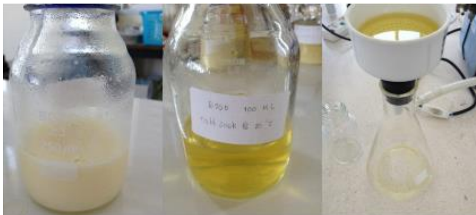
ภาพประกอบที่ 3-8 ขั้นตอนวิธีการ Cold Soak Filtration ในไบโอดีเซล
