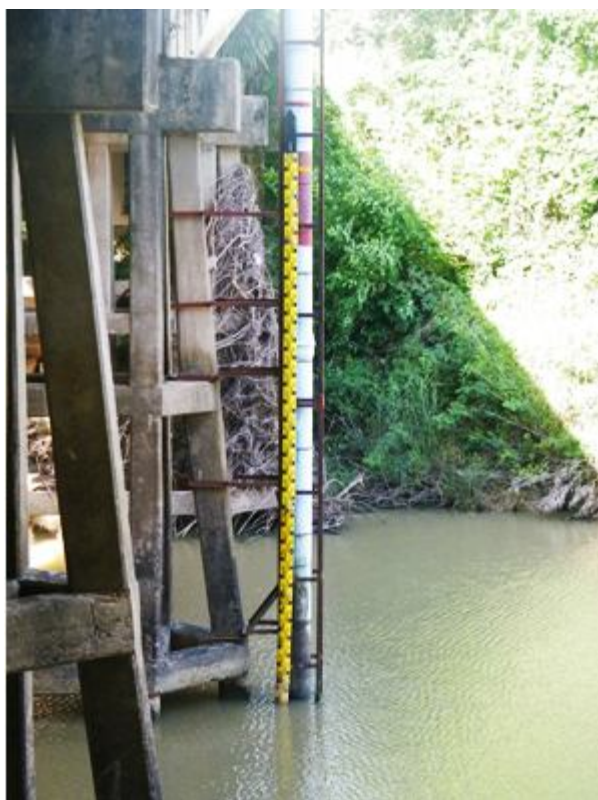
ภาพประกอบ 4-4 เสาวัดระดับน้ำสถานีบ้านบางศาลา X.90
