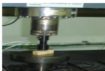
รูปที่ 3-17 ลักษณะไม้ตัวอย่างที่ใช้ในการทดสอบ (ซ้าย) และการทดสอบความแข็ง (ขวา)
