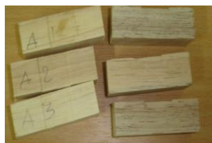
รูปที่ 3-16 ลักษณะไม้ตัวอย่างที่ทดสอบ (ซ้าย) และการทดสอบความเค้นอัดตั้งฉากเส้น (ขวา)
