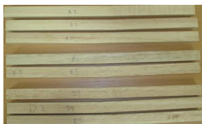
รูปที่ 3-18 ลักษณะไม้ตัวอย่างที่ใช้ในการทดสอบ (ซ้าย) และการทดสอบแรงดัด (ขวา)
