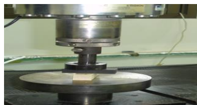
รูปที่ 3-16 ลักษณะไม้ตัวอย่างที่ทดสอบ (ซ้าย) และการทดสอบความเค้นอัดตั้งฉากเส้น (ขวา)
