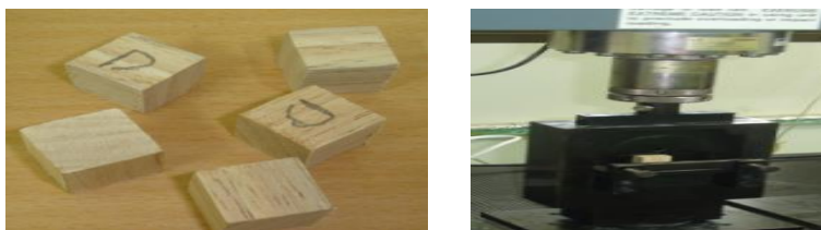
รูปที่ 3-14 ลักษณะไม้ที่ใช้ทดสอบ (ซ้าย) และการทดสอบความเค้นเฉือนขนานเส้น (ขวา)
