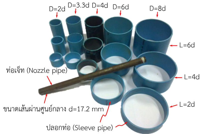
รูปที่ 19 แสดงท่อเจ็ทแบบปกติ และแบบปลอกท่อตามขนาดต่างๆ
