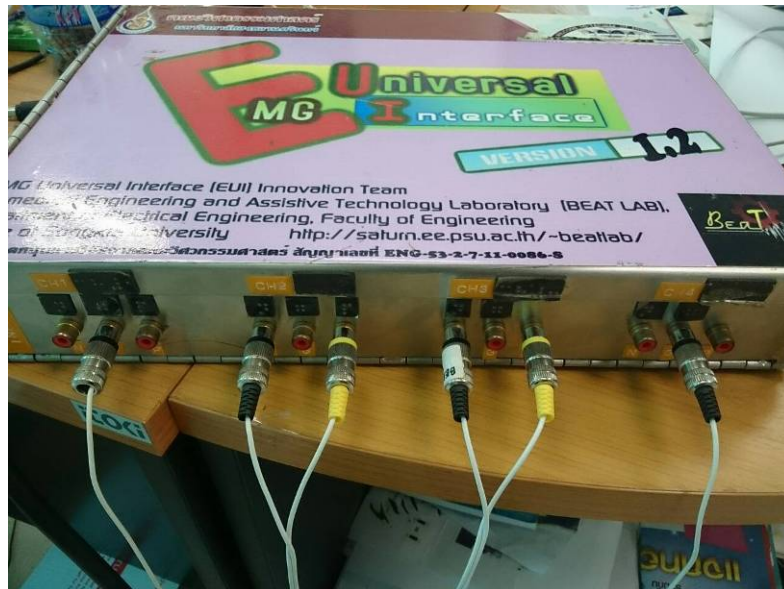
ภาพประกอบที่ 4 – 5 การต่อสายไฟจากอิเล็กทรอนิกส์ทรอดเข้าสู่เครื่องขยายสัญญาณ PSU_Beatlab_1
