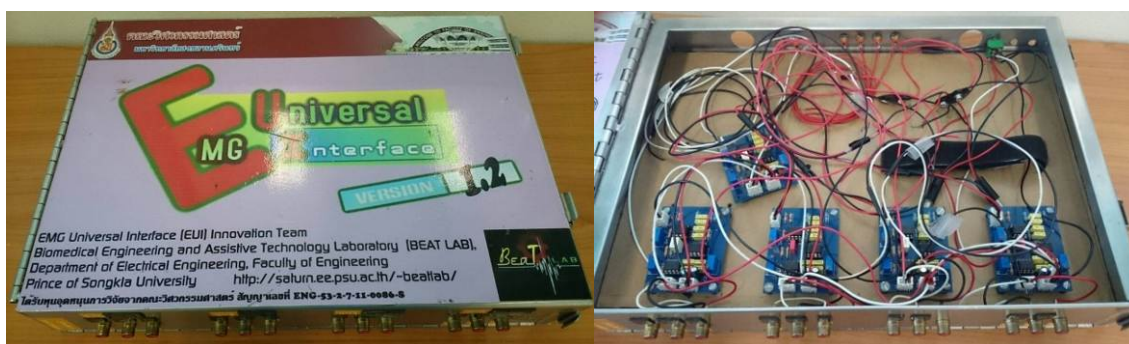
ภาพประกอบที่ 3 – 16 เครื่องขยายสัญญาณไฟฟ้ากล้ามเนื้อ (PSU_Beatlab_1)
