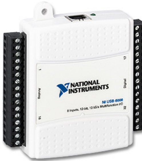
ภาพประกอบที่ 3 – 18 DAQ (Data acquisition card) รุ่น 6009 [17]
