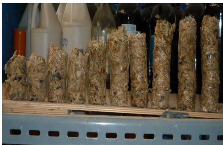
รูปที่ 2.2 ขนาดและความสูงเชื้อเพลิงอัดแท่งที่น้ำหนัก 30-120 กรัม
