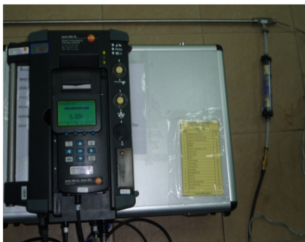
รูปที่ 2.8 เครื่องวัดก๊าซจากการเผาไหม้ (Testo 350 M/XL)
