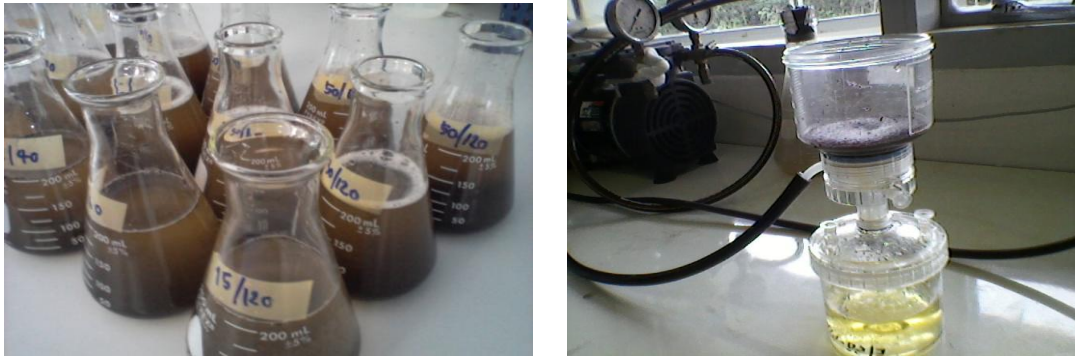
ภาพที่ 11 การทดสอบการละลายของปุ๋ยหมักมูลไส้เดือนดิน
