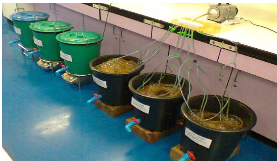
ภาพที่ 12 ชุดการทดลองการหมักภายใต้สภาวะเดิมอากาศและไม่เดิมอากาศ
