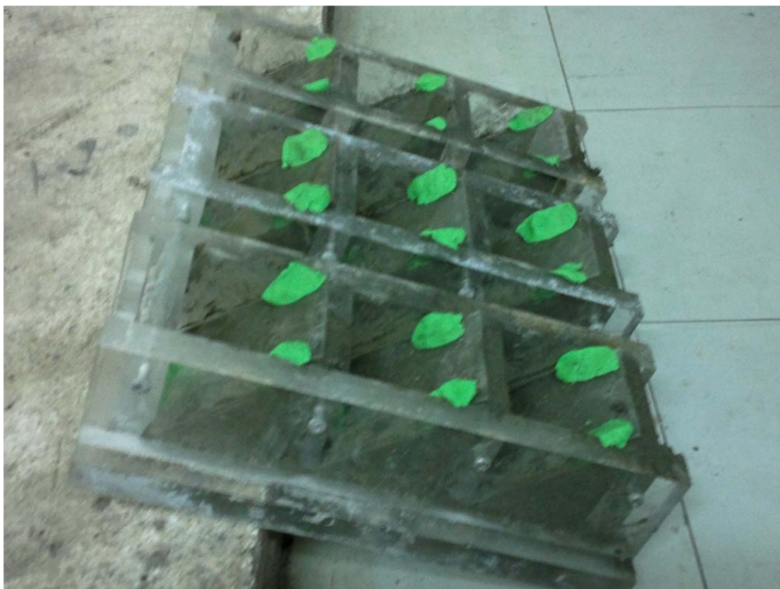
ภาพที่ ข-1 การหล่อก้อนตัวอย่างปูนซีเมนต์มอร์ตาร์
