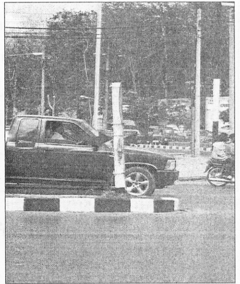
รูปที่ 2.8 : ขนาดของเสาที่ใช้ติดตั้งป้ายบอกสิ่งกีดขวางซึ่งใหญ่เกินความจำเป็น และเป็นอันตรายต่อผู้ขับขี่ที่พลาดพลั้ง
