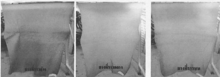
รูปที่ 5.24 ยางแผ่นรมควันที่ได้จากการรมควันยาง 6 แผ่น ด้วยระบบเผาไหม้ที่มีอิฐเก็บกักความร้อน
