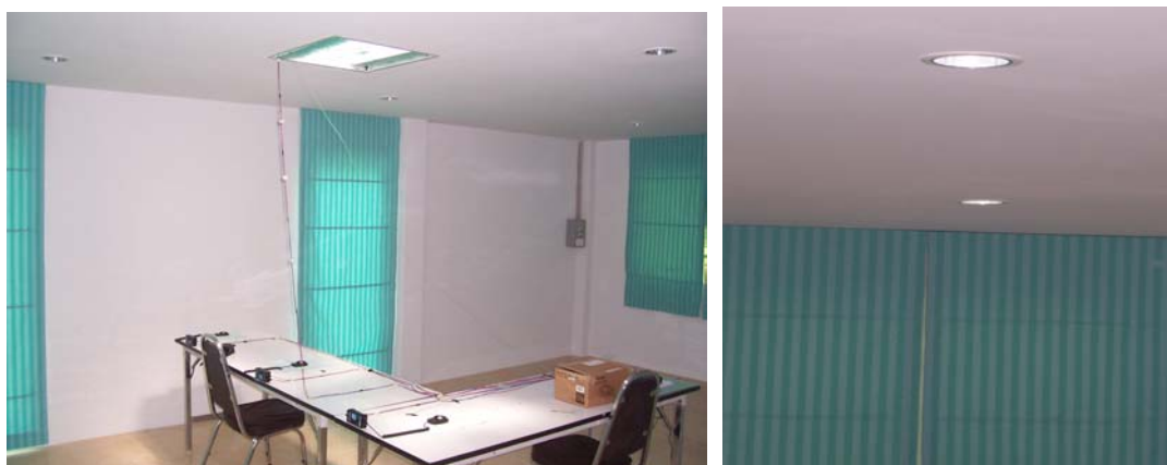
รูปที่ 5.8 ความส่องสว่างห้องวิจัยของการใช้ท่อนำแสงและระบบไฟฟ้าแสงสว่าง
