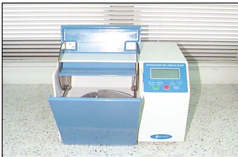
ภาพผนวกที่ 3 เครื่องปั่นอาหาร (Stomacher) ยี่ห้อ Seward
