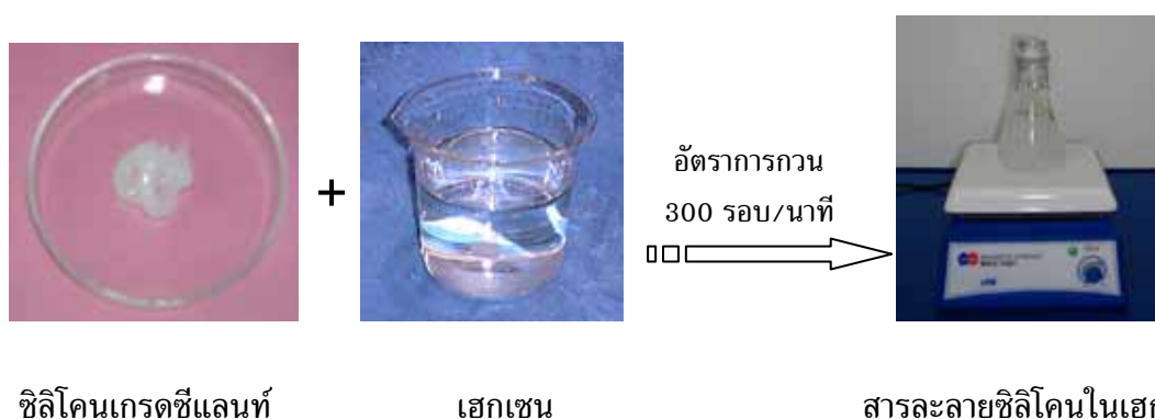
ภาพประกอบ 2.4 การเตรียมสารละลายซิลิโคนในเฮกเซน
