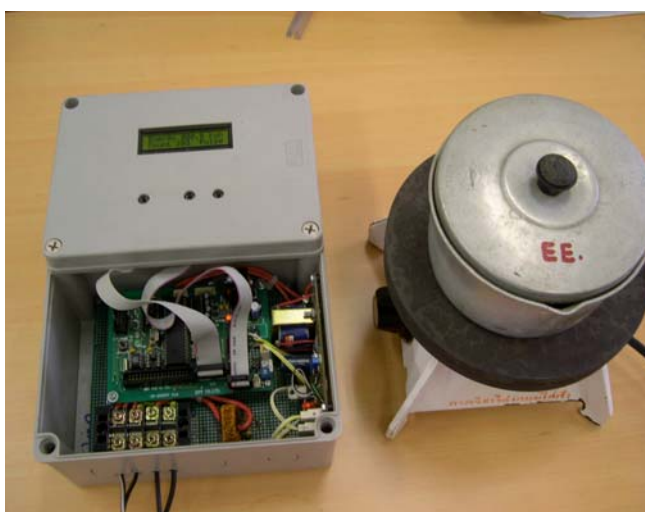
ภาพประกอบ 4-8 เครื่องต้นแบบมาตรวัดพลังงานไฟฟ้าขณะจ่ายโหลด
