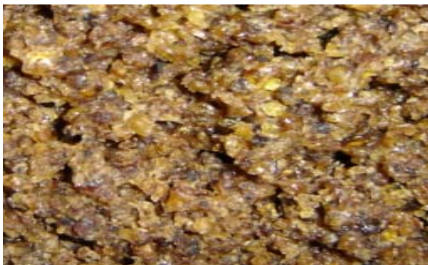
ภาพประกอบที่ 4.16 ลักษณะยางหลังจากอบแห้งด้วยอุณหภูมิอบแห้ง 130^{\circ}\text{C} ระยะเวลา 40 นาที ทิศทางลม จากบนลงล่าง และ 110^{\circ}\text{C} ระยะเวลา 180 นาที ทิศทางลม จากล่างขึ้นบน ความชื้นเริ่มต้น 46.5%มาตรฐานแห้ง ความเร็วลม 2.5 เมตรต่อวินาที (Exp.No.11)
