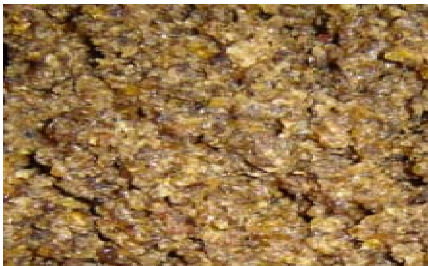
ภาพประกอบที่ 4.16 ลักษณะยางหลังจากอบแห้งด้วยอุณหภูมิอบแห้ง 130^{\circ}\text{C} ระยะเวลา 40 นาที ทิศทางลม จากบนลงล่าง และ 110^{\circ}\text{C} ระยะเวลา 180 นาที ทิศทางลม จากล่างขึ้นบน ความชื้นเริ่มต้น 46.5%มาตรฐานแห้ง ความเร็วลม 2.5 เมตรต่อวินาที (Exp.No.11)
