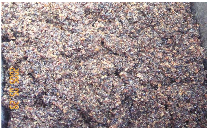
ภาพประกอบที่ 4.8 ยางหลังอบแห้งด้วยอุณหภูมิ 130^{\circ}\text{C} ใช้เวลา 220 นาที
