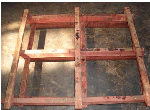
ภาพประกอบที่ 3.6 พาลเลตหรือไม้หนูนชนิดที่เป็นเหล็ก
