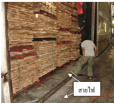
ภาพประกอบที่ 3.7 ลักษณะของสายไฟที่ใช้ต่อออกมาเพื่อตรวจสอบค่าความชื้นของไม้
