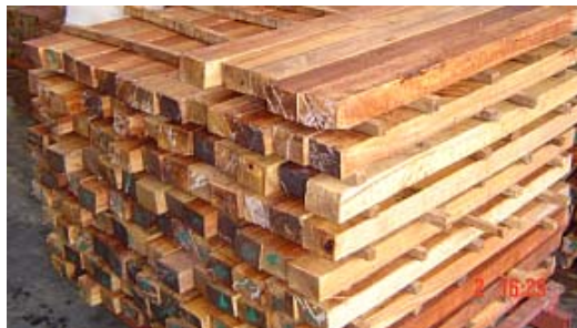
ภาพประกอบที่ 3.2 ไม้ยางพาราที่ผ่านการอัดน้ำยามาแล้ว
