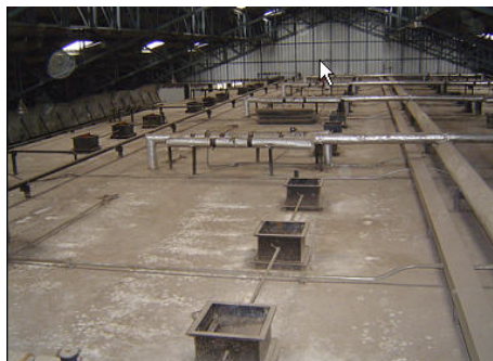
ภาพประกอบที่ 3.16 ช่องระบายความชื้น มองจากด้านบนหลังเตาอบ
