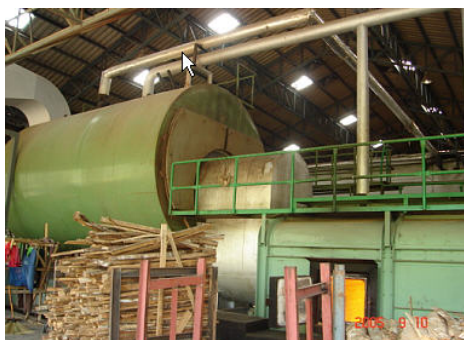
ภาพประกอบที่ 3.10 หม้อต้มน้ำที่ใช้เป็นแหล่งกำเนิดพลังงานจากการเผาไหม้
