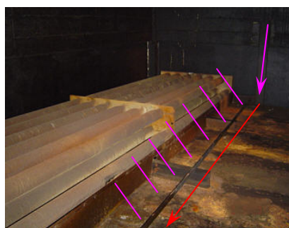
ภาพประกอบที่ 3.14 ลักษณะการสเปรย์จ่ายไอน้ำ
