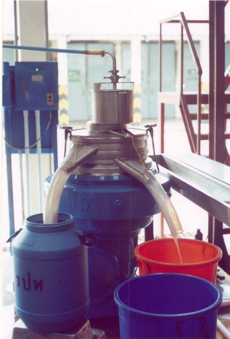
**Fig. 13** de Larval centrifuge (type 410A-79M/3786).
