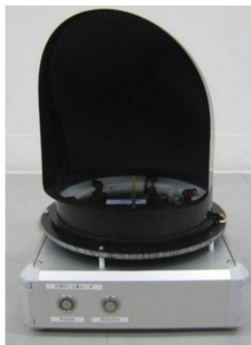
ภาพประกอบที่ 1.27 สายอากาศแบบสะท้อนรูปพาราโบลา [9]
