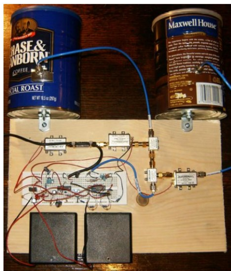
ภาพประกอบที่ 1.18 อุปกรณ์ชุด Radar kit ประกอบด้วยวงจร และสายอากาศ [6]
