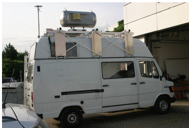
ภาพประกอบที่ 1.47 สายอากาศแถวลำดับแบบคงรูปถูกติดตั้งบนยานพาหนะ
