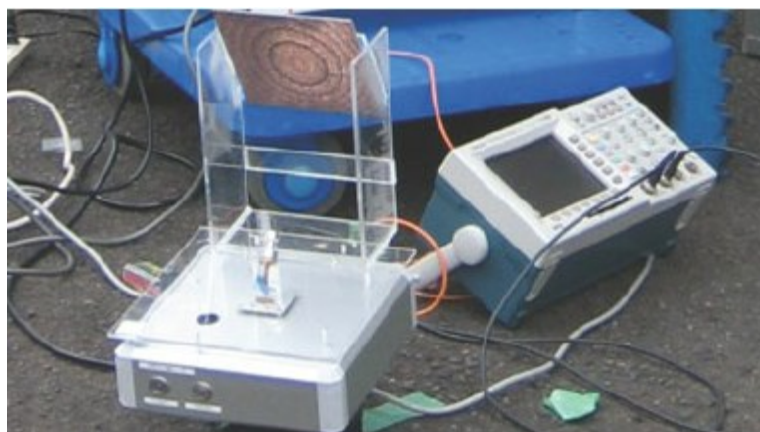
ภาพประกอบที่ 1.28 สายอากาศแกลวลำดับแผ่นสะท้อน ถูกติดตั้งบนโรตเตอร์ [9]
