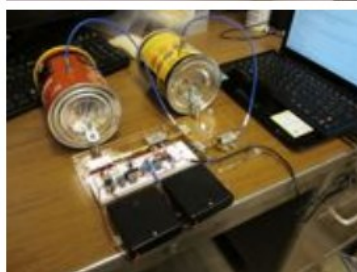
ภาพประกอบที่ 1.20 การทดสอบสายอากาศในระบบเรดาร์ SAR [6]
