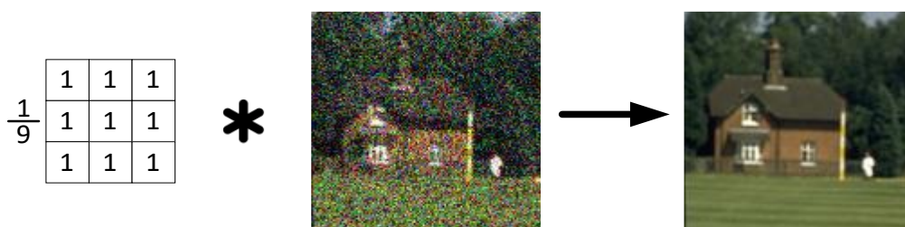
ภาพประกอบ 1-11 ตัวอย่างการ convolution ภาพถ่ายที่มีสัญญาณรบกวนด้วย average filter
