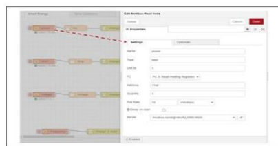
รูปที่ 10 การตั้งค่าเชื่อมต่ออุปกรณ์ IOT2050 ผ่านทางพอร์ท Serial RS-485 Protocol Modbus RTU
